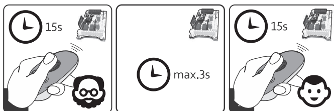
Rys.4 Zdalne dopisanie pilota 15s/15s.
