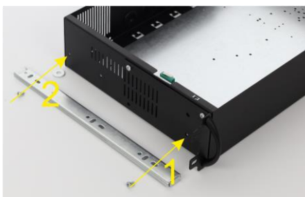
Przykręć prowadnicę dwoma śrubami do obudowy ARAD (pamiętaj o podkładce dystansowej pod drugą śrubą)
