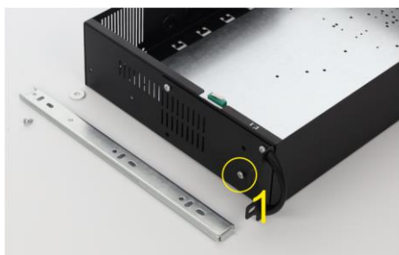
Odkręć pierwszą śrubę M4 z obudowy ARAD
